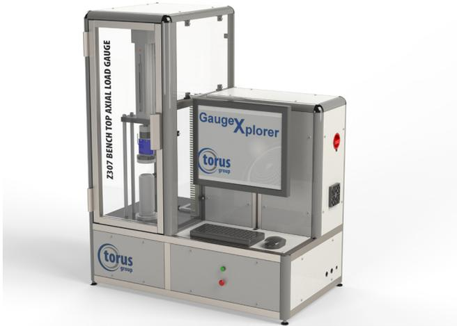
La galga semiautomática de carga axial de sobremesa Z307 determina la fuerza de carga axial máxima que puede aplicarse antes de que falle el contenedor en un tiempo de ciclo corto.
