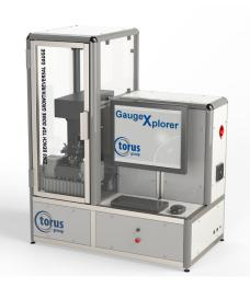
La galga de crecimiento/inversión del domo Z308 proporciona información detallada sobre el cambio global en la longitud de la lata cuando se aplica y posteriormente se retira la presión.
