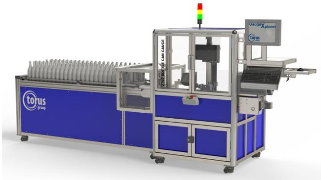
La galga automática de inspección de latas de botellas Torus Z702 ha sido desarrollada para inspeccionar todas las dimensiones críticas de una botella de aluminio de 2 piezas.
