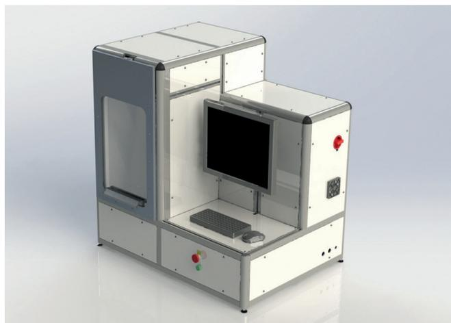
La galga semiautomática de ráfagas de aerosoles B303 se fabricó para verificar que los aerosoles de producción cumplan con los requisitos mínimos de deformación y presiones de ráfaga.
