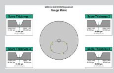
En los gráficos de sección, se ve el perfil de puntuación para controlar la vida útil.
