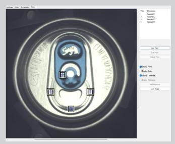
Basta con configurar las posiciones de medición mediante una interfaz de arrastrar y soltar en una imagen de la línea que se va a medir.
