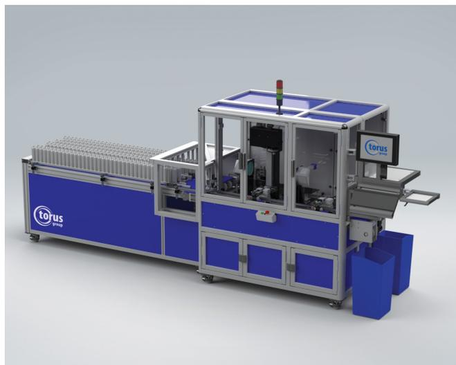
La galga automática de inspección de latas de aerosol acabadas Torus Z702 se fabricó para inspeccionar todas las dimensiones críticas de una lata de aerosol.
